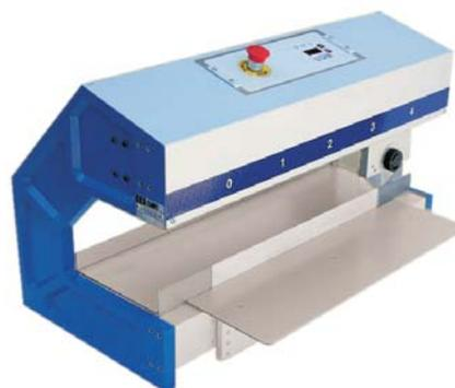
Tractor 2 separa circuiti stampati precisi sia di piccole che di grandi dimensioni, la lunghezza di taglio è 450mm. Il PCB viene appoggiato con il solco preinciso sulla lama lineare e la lama circolare viene fatta scorrere a mano, o con motore, sul solco superiore. La distanza fra la lama circolare superiore e la lama lineare inferiore è regolabile.
