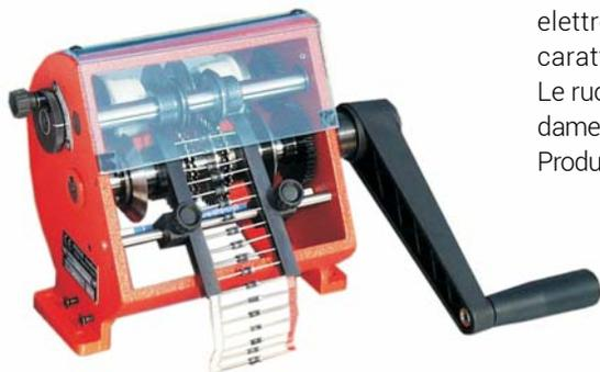
La macchina Superform-A esegue il taglio e la piegatura dei terminali dei componenti elettronici assiali nastrati. Il dispositivo è solido e compatto e sua particolare caratteristica è la possibilità di preformare terminali con Ø fino a 1,4 mm.
