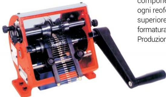
La macchina SUPERFORM/AP esegue il taglio e la piegatura dei terminali dei componenti elettronici assiali nastrati con in più la sagomatura di un ricciolo su ogni reoforo. Si possono preformare reofori con Ø non inferiore a 1 mm e non superiore a 1,4 mm. È possibile escludere le due ansine sostituendo i 2 coltelli taglio/formatura con i coltelli di solo taglio (opzionali).
